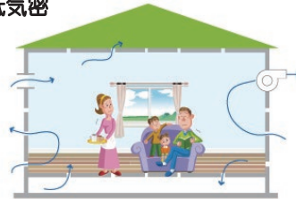
隙間が多いので室内外の空気の出入りを把握することもコントロールすることもできない
